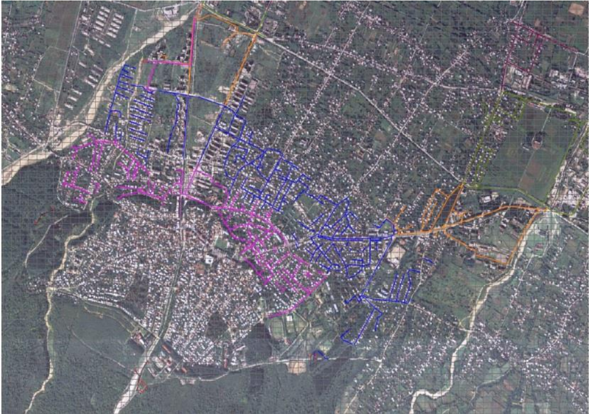
სურათი №3. თელავის წყალმომარაგების ქსელის სიტუაციური ნახაზი
